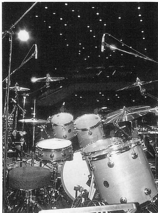
ドラム全体のマイキングの様子。トップに「ノイマンKM84」、ハイハットに「AKG・C451」、タムに「エレクトロボイスN/D408」がそれぞれセッティングされている
