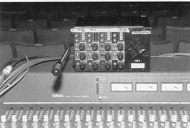
ハウス・コンソールの左上に設置されていた、山寺氏お気に入りのゲート・コンプレッサー「アフェックスCX1」
