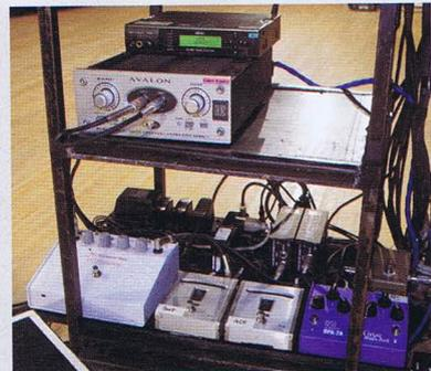
▲本番ではウェッジ・モニターからの出力がごく小さな音量に抑えられ、主に両耳のインイア・モニターが使われた。角松の持ち場には、ワイアレス・インイア・モニター・システムの送信機MIPRO MT-808Tのほか、DIのAVALON DESIGN U5やリミッターのRETROSPEC The Squeeze Box、プリアンプのCREWS MANIA C SOUND DPA-2Aなどギター用のツールも設置
