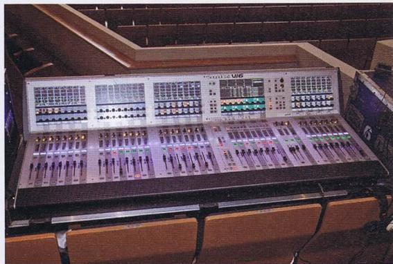
▲FOHではSOUNDCRAFTの64chデジタル卓、V16が使用された。V16は、ステージ上のサウンドを入力するためのステージ・ボックス、40ビット浮動小数点演算で信号を処理するDSPエンジンを内蔵したローカル・ボックス、フェーダー×32本などの操作子を備えたコントロール・サーフェスから構成されている。写真はコントロール・サーフェスだ
