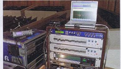
▲写真右のラックには、スピーカー・プロセッサのXTA ELECTRONICS DP224やグラフィックEQのKLARK TEKNIK DN300×2台、DN3600などを設置
