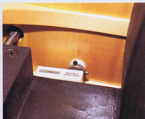
▲山寺氏はグランド・ピアノの響板の裏にYAMAHICOのピックアップを設置。とても近い音が得られるそうで、空気感を帯びたC414 B-ULSの音に混ぜて使っているという。またハウリングを起こしにくいため、ピアノのモニター音量を上げる際も便利だそう
