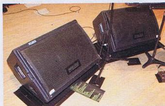
▲角松の足元に設置されたウェッジ・モニターは、15インチ・ウーファーと2インチ・ドライバーを備えた2ウェイ。山寺氏によると、両耳にインイア・モニターを装着していても、ウェッジの音は「体で感じる音」として機能するという
